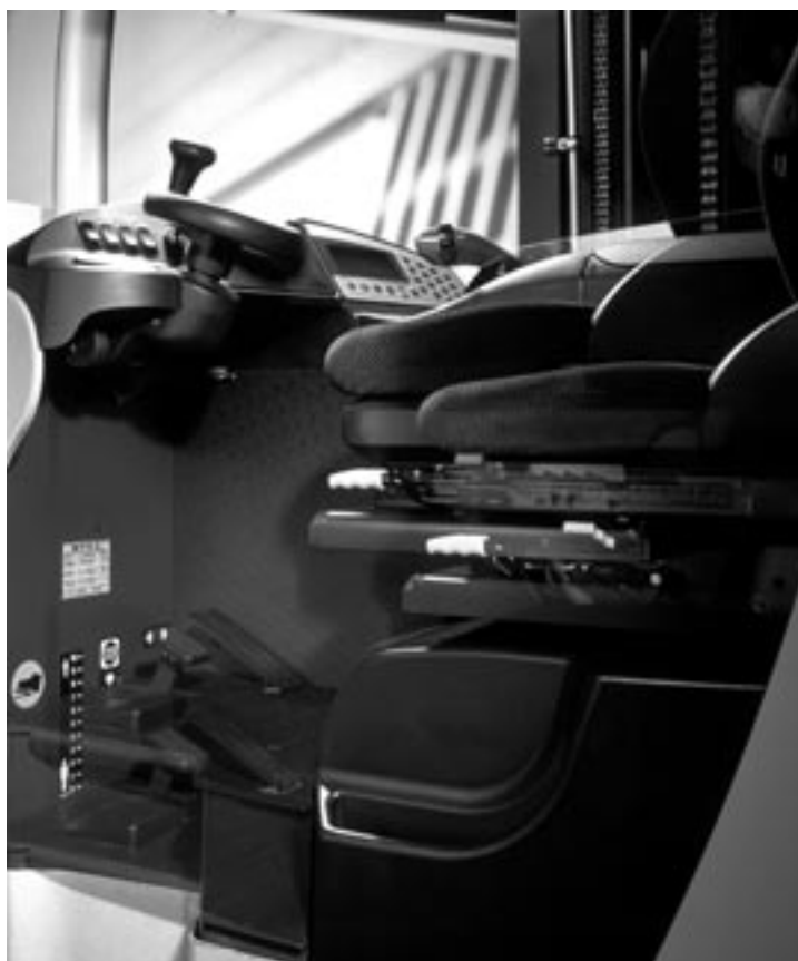
El puesto de conducción puede ser adaptado a todo estatura de conductor con el ajuste opcional de asiento y placa de los pies.
